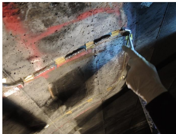
Abbildung 6: Abschnittsweise Verkleben des faseroptischen Sensors
